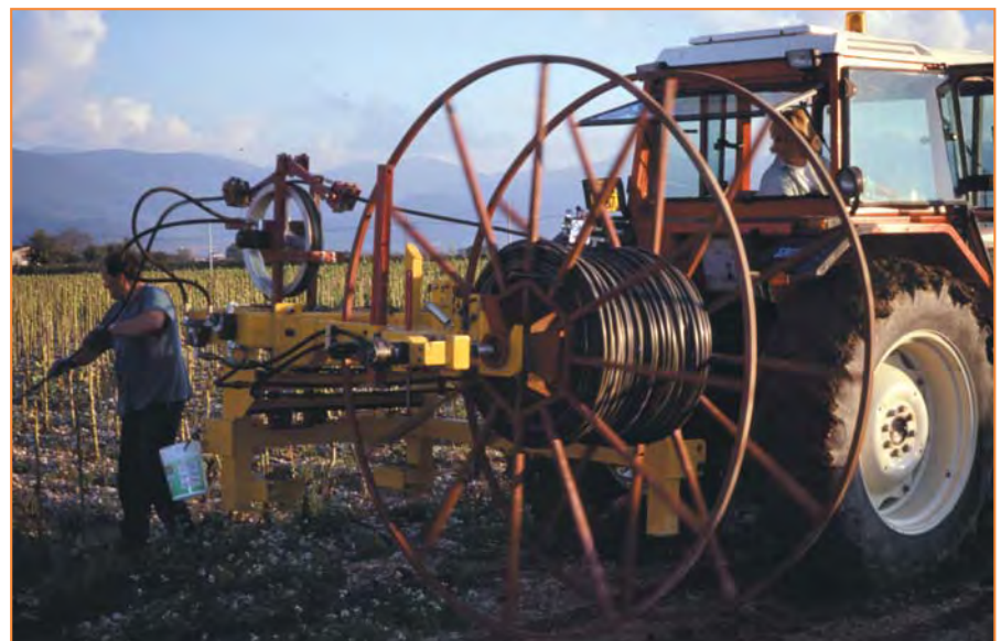
Macchina per stendere e raccogliere l'ala gocciolante
