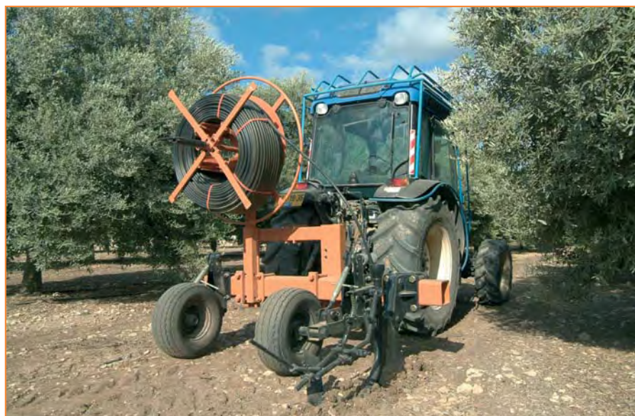
Macchina per la posa dell'ala in subirrigazione
