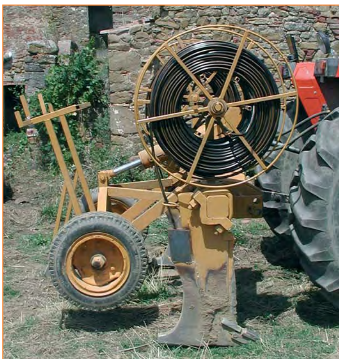
Esempio di macchina utilizzata per la messa in opera di un impianto di subirrigazione
