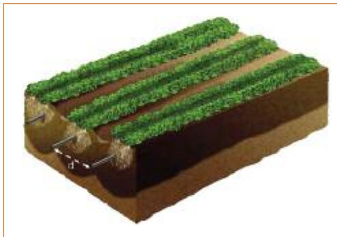
PROFILO BAGNATO SU ORTIVE A FILA BINA O SU ESTENSIVE IN SUBIRRIGAZIONE
