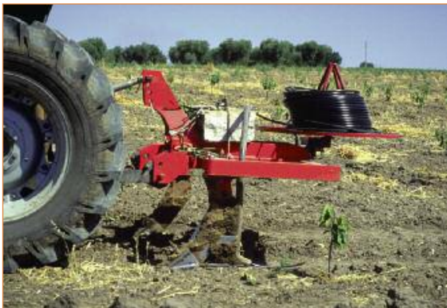
RIPUNTATORE MODIFICATO PER LA POSA IN SUBIRRIGAZIONE DELL'ALA GOCCIOLANTE
